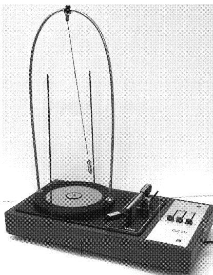
Obr. 2 Foucaultův pokus v malém – s využitím gramofonu
